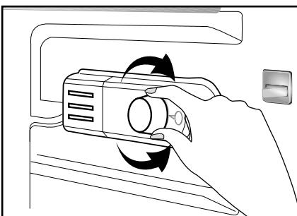
**Η θερμοκρασία λειτουργίας ρυθμίζεται από το θερμοστάτη.**
