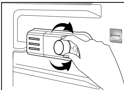
**La temperatura di funzionamento è regolata con il comando temperatura.**
