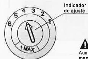
A gaveta do abrillantador tem 6 níveis. Inicie sempre no nível 4 e se detetar manchas ou problemas de secagem, aumente a quantidade de abrillantador aumentando a regulação para o nível 5. Se o resultado não for o desejado, volte a subir o nível de abrillantador, até que as manchas desapareçam. O nível recomendado é o valor que vem ajustado de fábrica, o qual é de "4"
