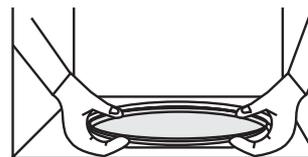
Não se esqueça de voltar a colocar o sistema de tracção, o suporte de rodinhas e o prato giratório.
