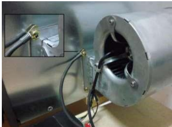
Esquerda Figura 9: ventilador janela na posição 2 ou 3, com anti-vibração do parafuso instalado. Direito Figura 9: ventilador amarrado na janela com sonda NTC preso entre parafuso e quadro fã
