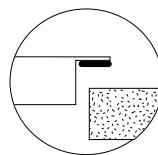
Een soldeerverbinding garandeert de waterdichtheid met het werkvlak.
