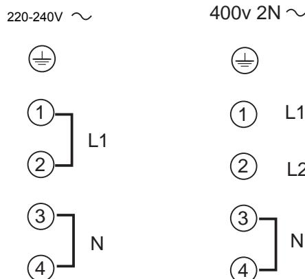
Deze kookplaat dient als volgt op het elektriciteitsnet te worden aangesloten :
