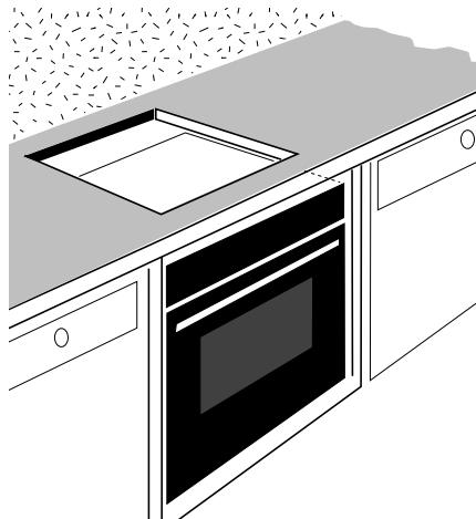
La table peut être encastrée directement dans le plan de travail au dessus du four en position haute. (distance minimum 10 mm)
