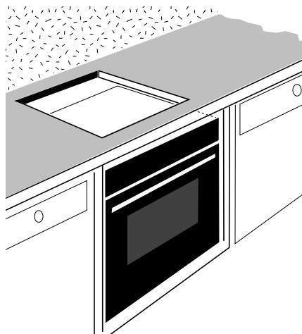
**U** kan de kookplaat direct in het werkblad boven de oven inbouwen (minimale afstand : 10 cm).
